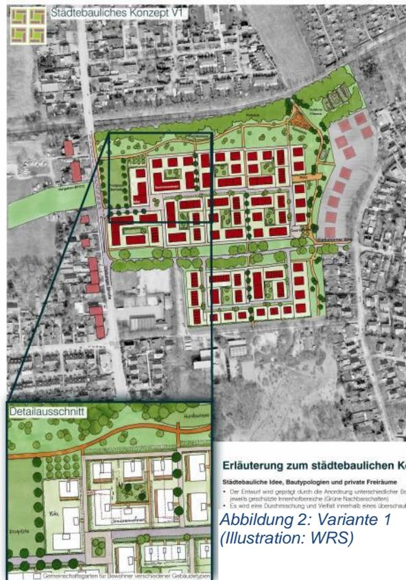
Der Entwurf wird durch die Anordnung unterschiedlicher Bautypologien um jeweils geschützte Innenhofbereiche geprägt.
