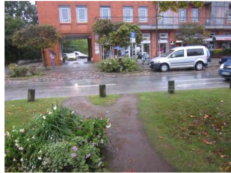
Trampelpfade im Mittelgrünstreifen weisen auf ungesicherte Querungsstellen hin. Insbesondere bei Rückstau des Kfz-Verkehrs ist eine Querung gefährlich
