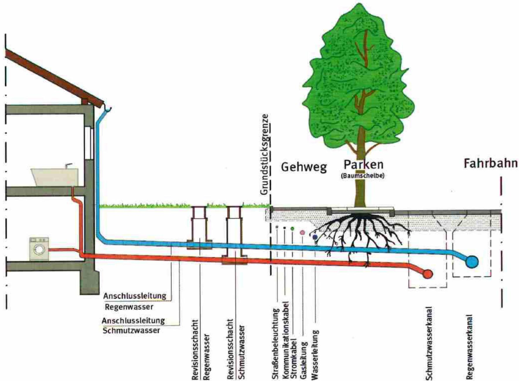
Bild 3: Schematische Darstellung von Baum und unterirdischen Leitungen
