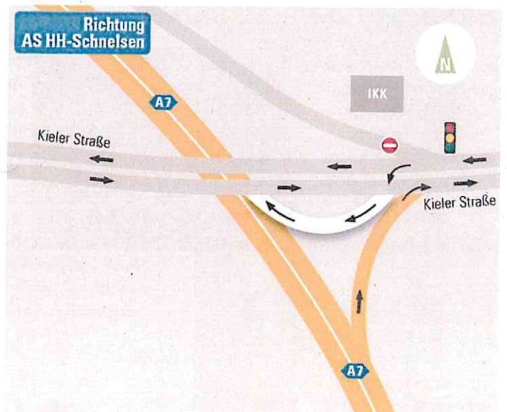
Abb. 3: Provisorische Autobahnauffahrt an der Kieler Straße
