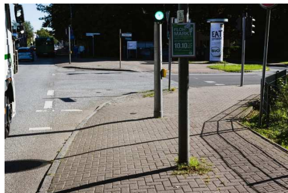
Abbildung 6: abgesetzte Furt mit Einbauten an der Segeberger Chaussee (Foto: Philipp Böhme)
