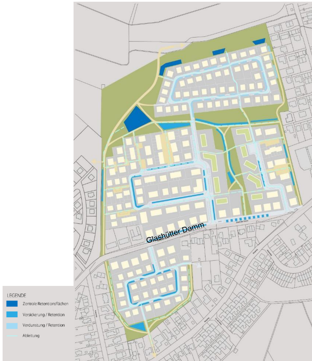
Abbildung 21: Entwässerungskonzept (siehe Anlage 12)
