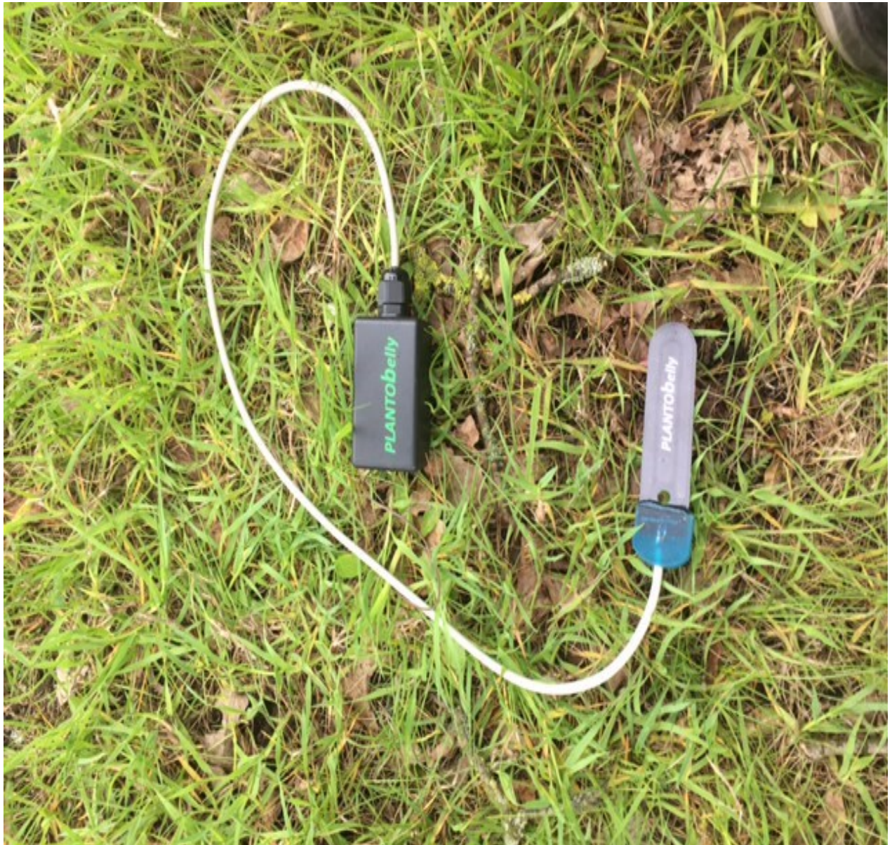
Abbildung 2: Feuchtigkeitssensor mit Sendeeinheit und Batterie
