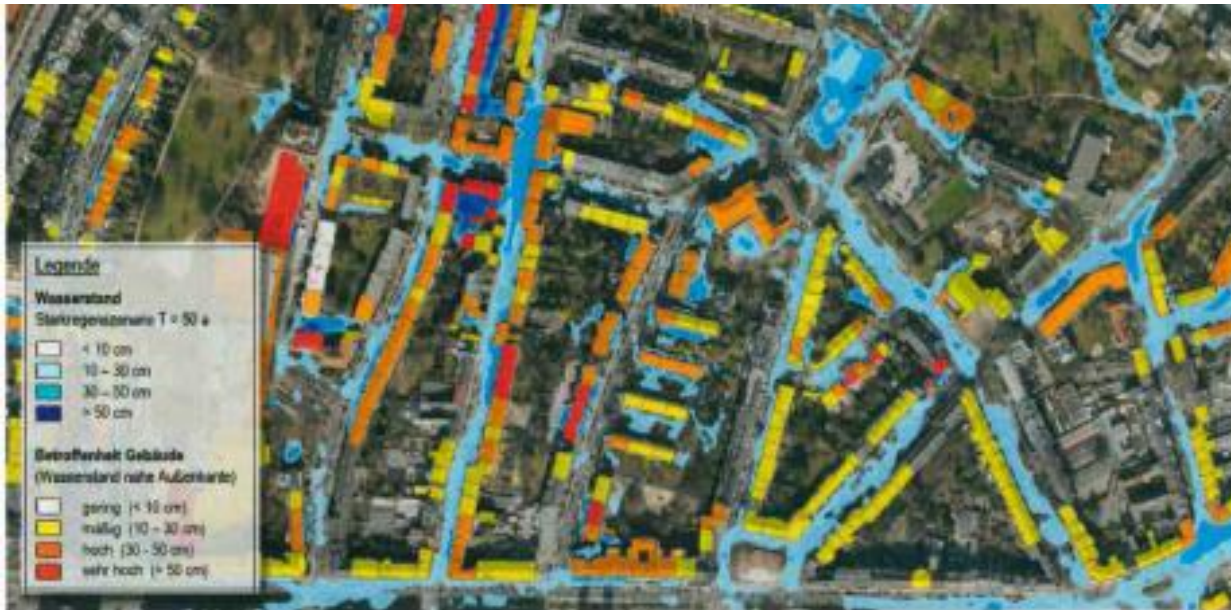
Bild 13: Beispiel einer Gefahrenkarte (Kartenausschnitt) mit klassifizierter Kennzeichnung von Wasserständen ( T_{50} = 50 a) und Gebäudebetroffenheiten als „vereinfachte Risikokarte“ (Quelle: ILLOEN 2015)
