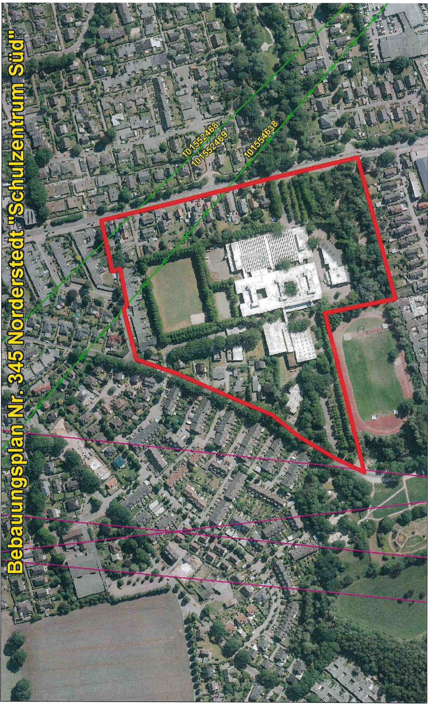
Die farbigen Linien verstehen sich als Punkt-zu-Punkt-Richtfunkverbindungen der Telefónica Germany GmbH & Co. OHG. Das Plangebiet ist im Bild mit einer dicken roten Linie eingezeichnet.
