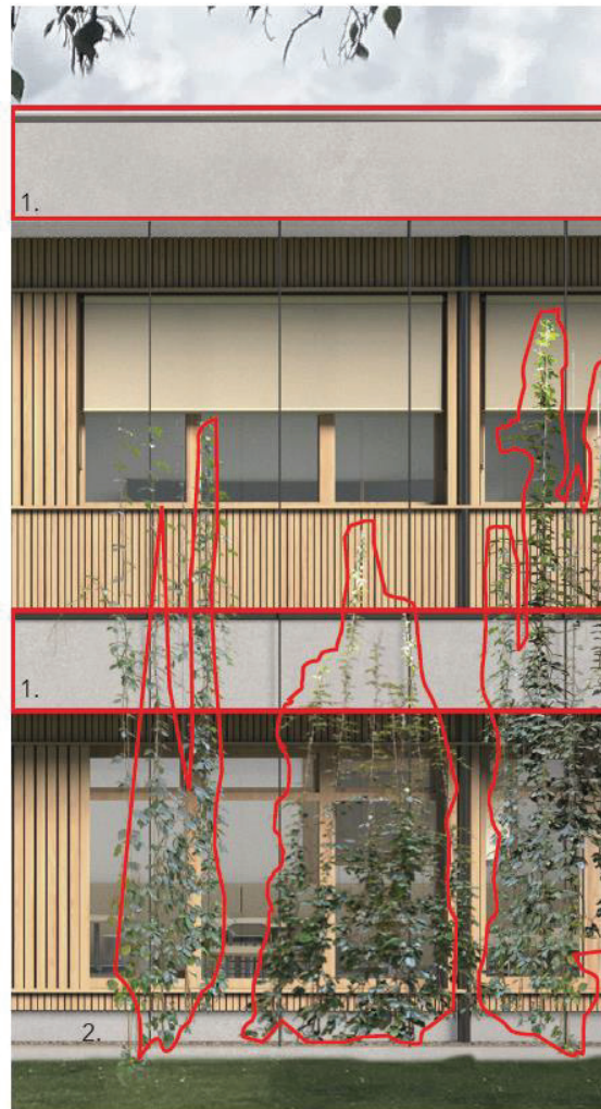
1. Auskragung Reinigungsbalkon mit Faserzementplatten 2. Fassadenbegrünung zur Verbesserung der Öko-Bilanz Stand Entwurfsplanung
