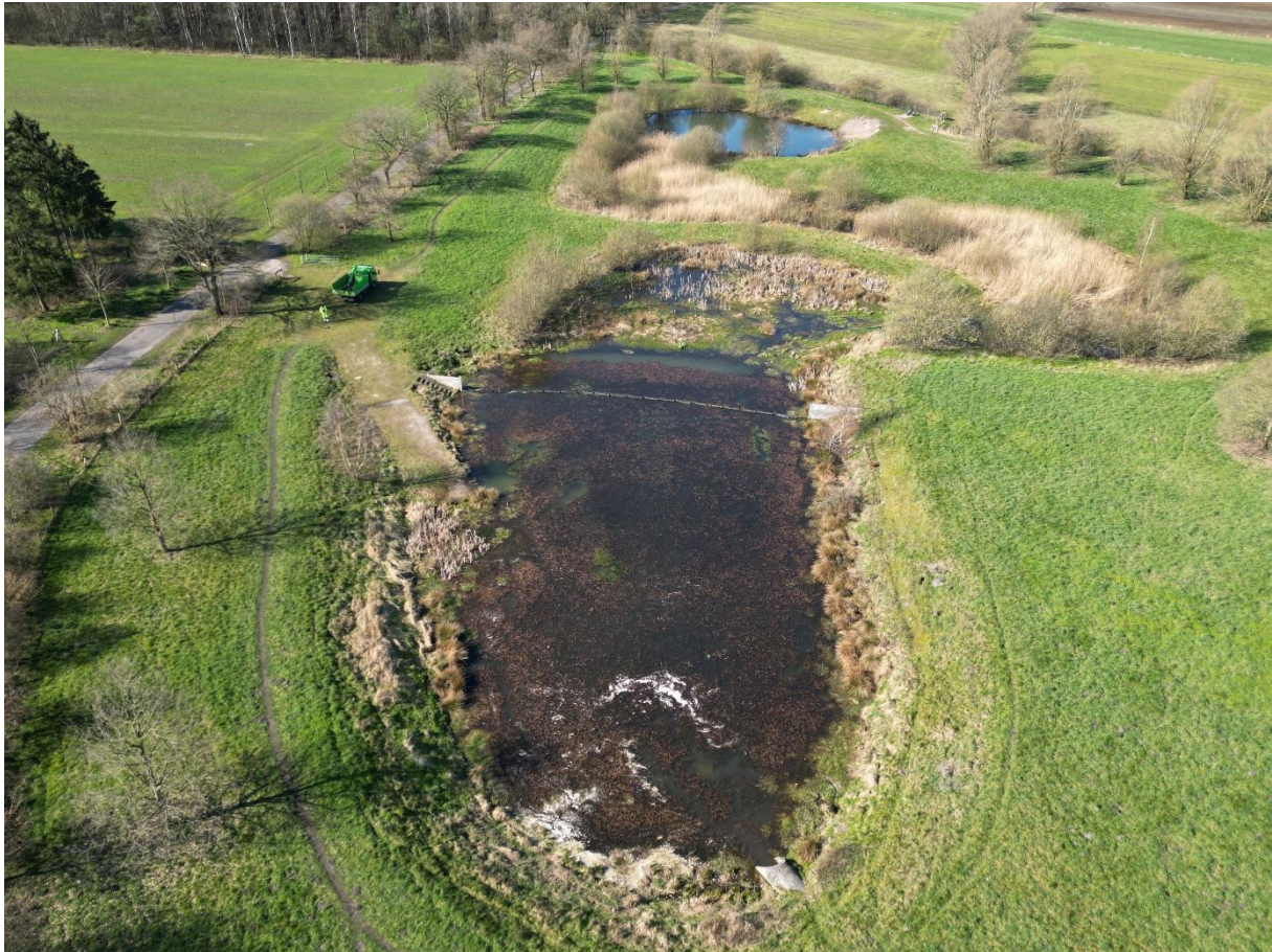
Das Regenrückhaltebecken im Dreibekenweg aus der Luft. Sehr gut zu erkennen sind hier die Farbrückstände auf der Wasseroberfläche, welche vom Ufer nicht erkennbar sind.
