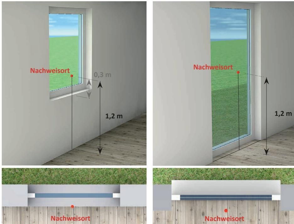
Abb. 16: Positionierung des Messpunktes im Innenraum (Eigene Darstellung)
